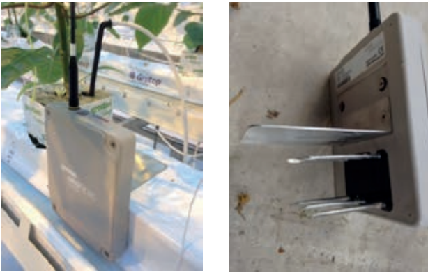
Figuur 8 Grosens sensor geplaatst in steenwolmat ter registratie van watergehalte, geleidbaarheid en temperatuur in de mat (3 sensoren per afdeling).
