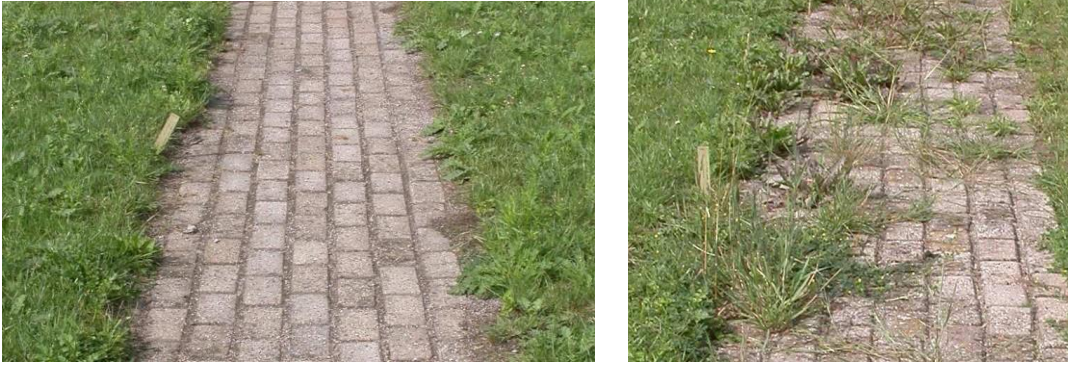
Figuur: klinkers met geomix voegvulling (links) en klinkers met standaard brekerzand (rechts), twee jaar na aanleg. (foto's proefveld PRI)
