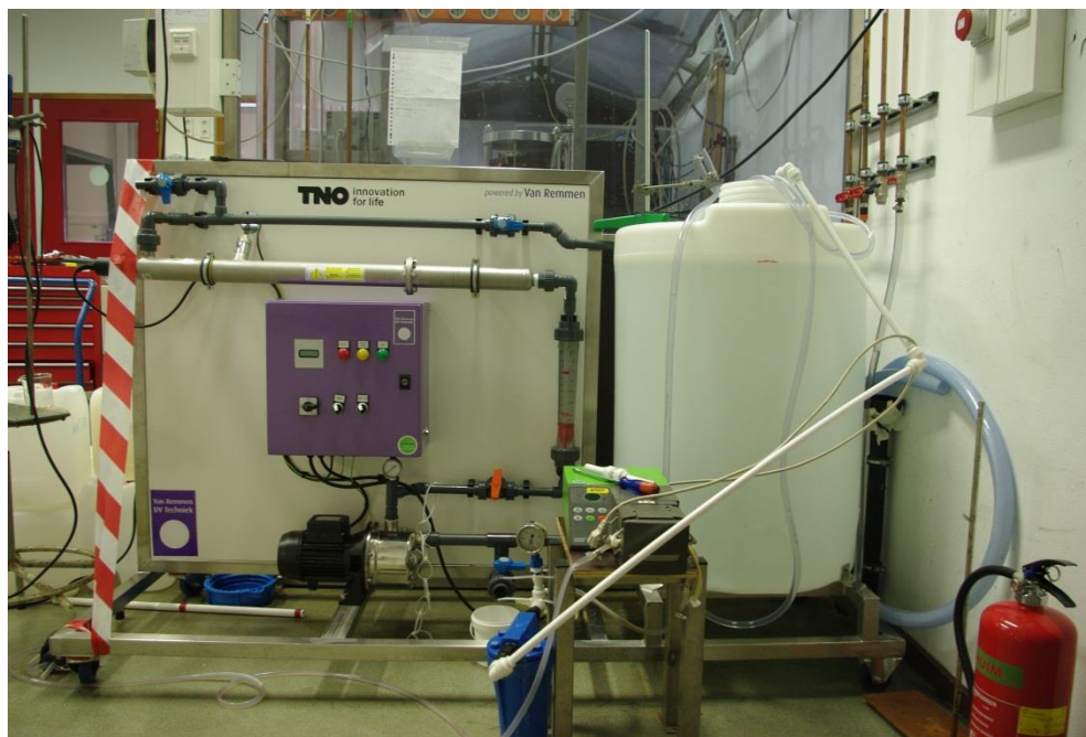
Figuur 11: Experimentele opstelling gebruikt voor de experimenten met UV/H 2 O 2
