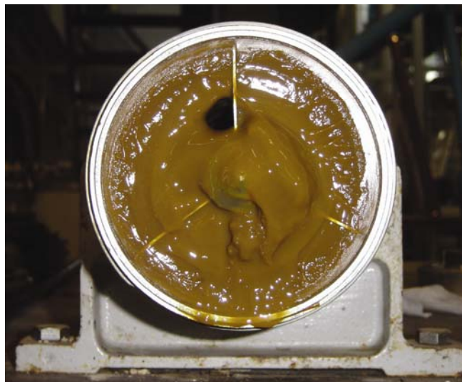
Figuur 14: Isoleren van lignine uit tarwe stro (Foto: Paulien Harmsen).
