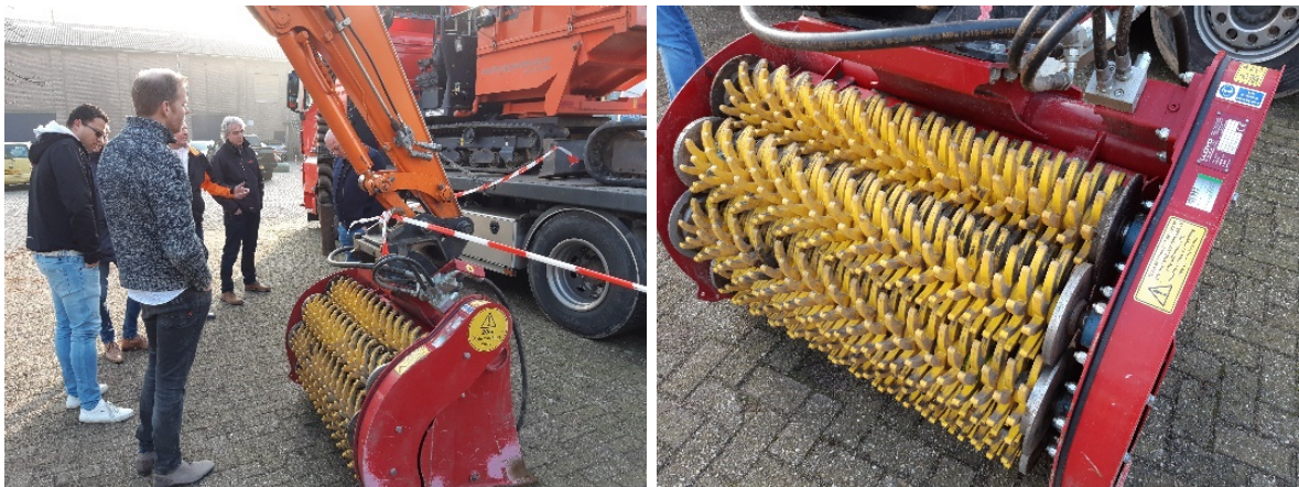
Figuur 9 Mobile kraan met een graafbak met roterende 'vingers' voor graven en uitzeven. De grond valt door de bak, grovere delen (>2 cm) blijven achter in de bak.
