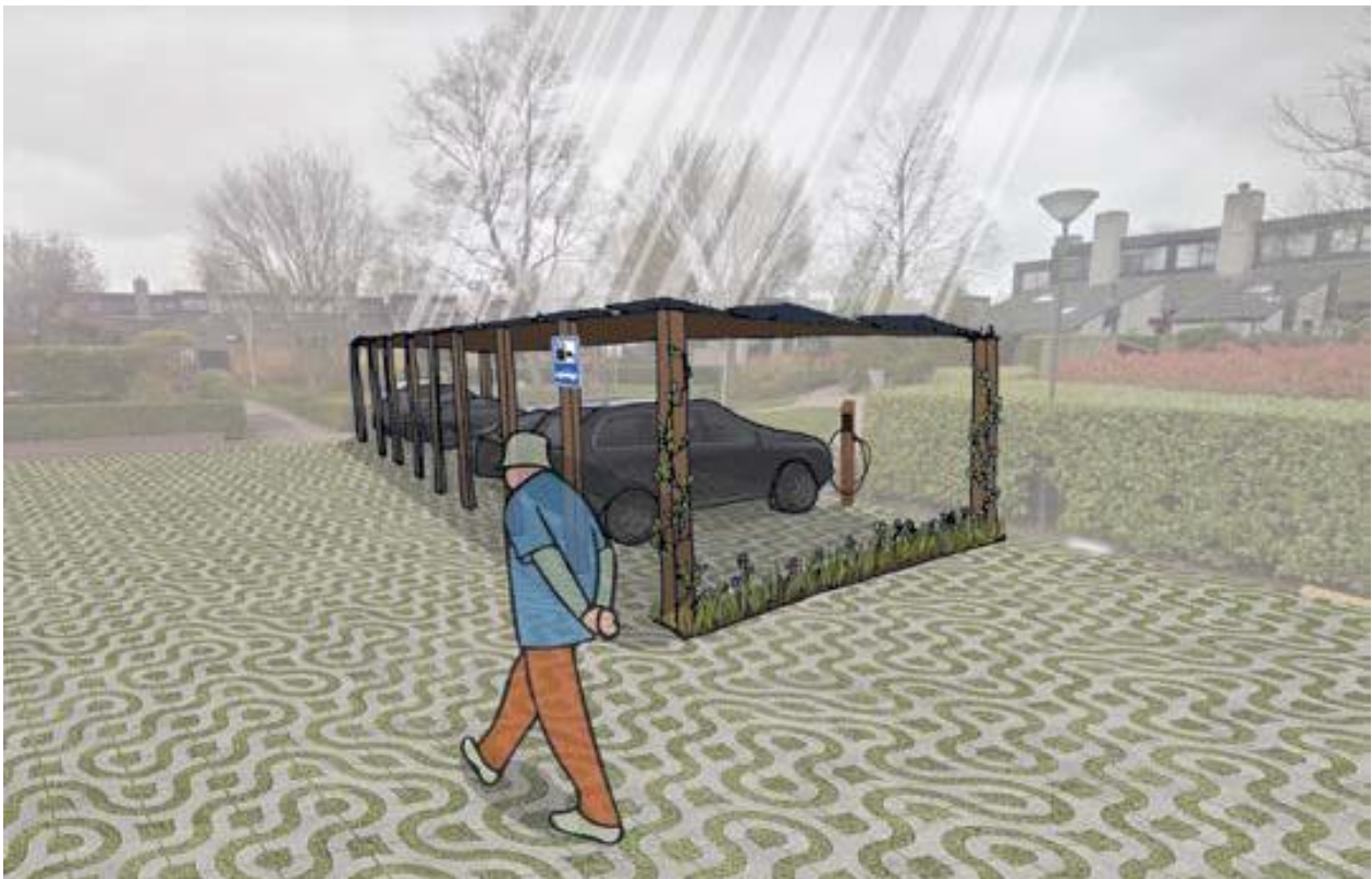
Figuur 19 Zonnepanelen op gezamenlijke parkeerplaats en waterdoorlatende bestrating (Meekel, 2022).
