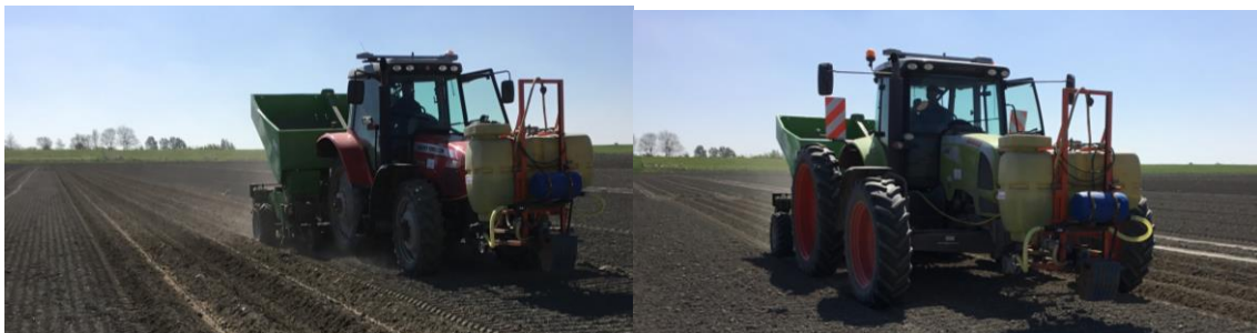
Figuur 12: Poten van de proef, met links de 1,5m spoor trekker(foto van vorig jaar, dit jaar is gepoot met een claas op 1,5m) en rechts de 3,2m breedspoor trekker, de rest van de poot-combinatie is identiek.
