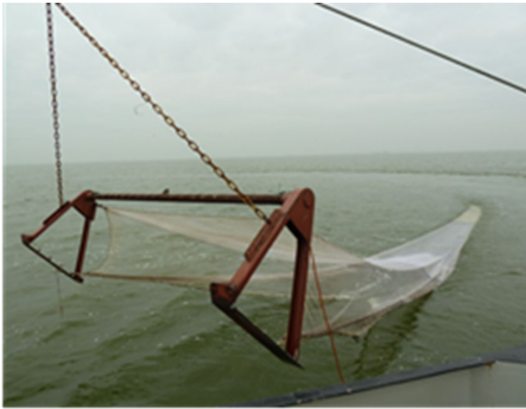
Figuur 3.5 Verhoogde 4-m boomkor in actie tijdens de reguliere monitoring op IJsselmeer en Markermeer.
