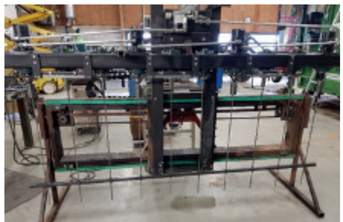
Machine voor boren van gaten in de grond
