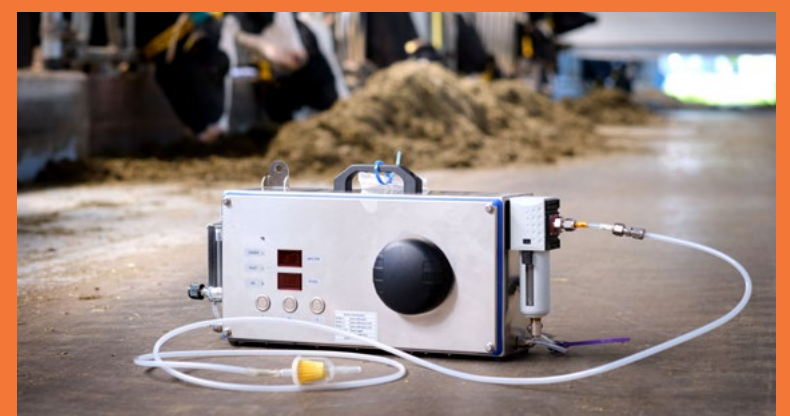
De metingen worden genomen met een 'sniffer' die methaanconcentraties meet in de voerbak van de melkrobot
