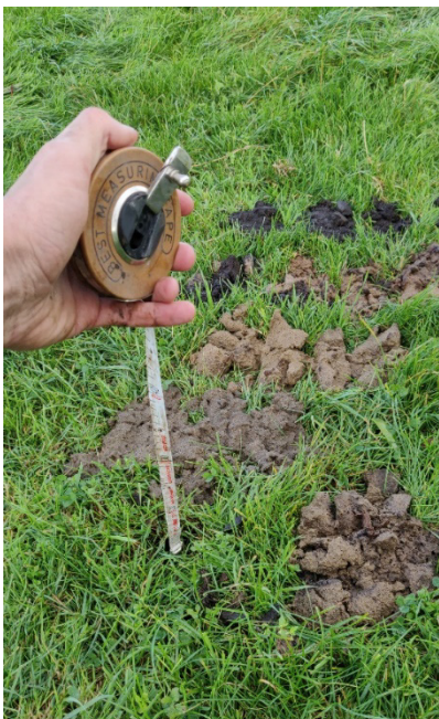
Figuur 4 Handmatige meting van de grondwaterspiegeldiepte in een boorgat.
