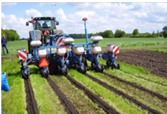
Maïs in graszode zaaien met het strokenfreessysteem (systeem Pol, links) en met de Hunter van Evers-Agro (rechts)
