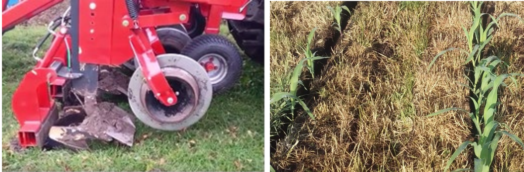
Ondergrondse strokenploeg (links) en maïs in graszode met ondergrondse strokenploeg (rechts).
