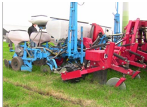
Maïs in graszode zaaien met het strokenfreessysteem (systeem Pol, links) en met de Hunter van Evers-Agro (rechts)
