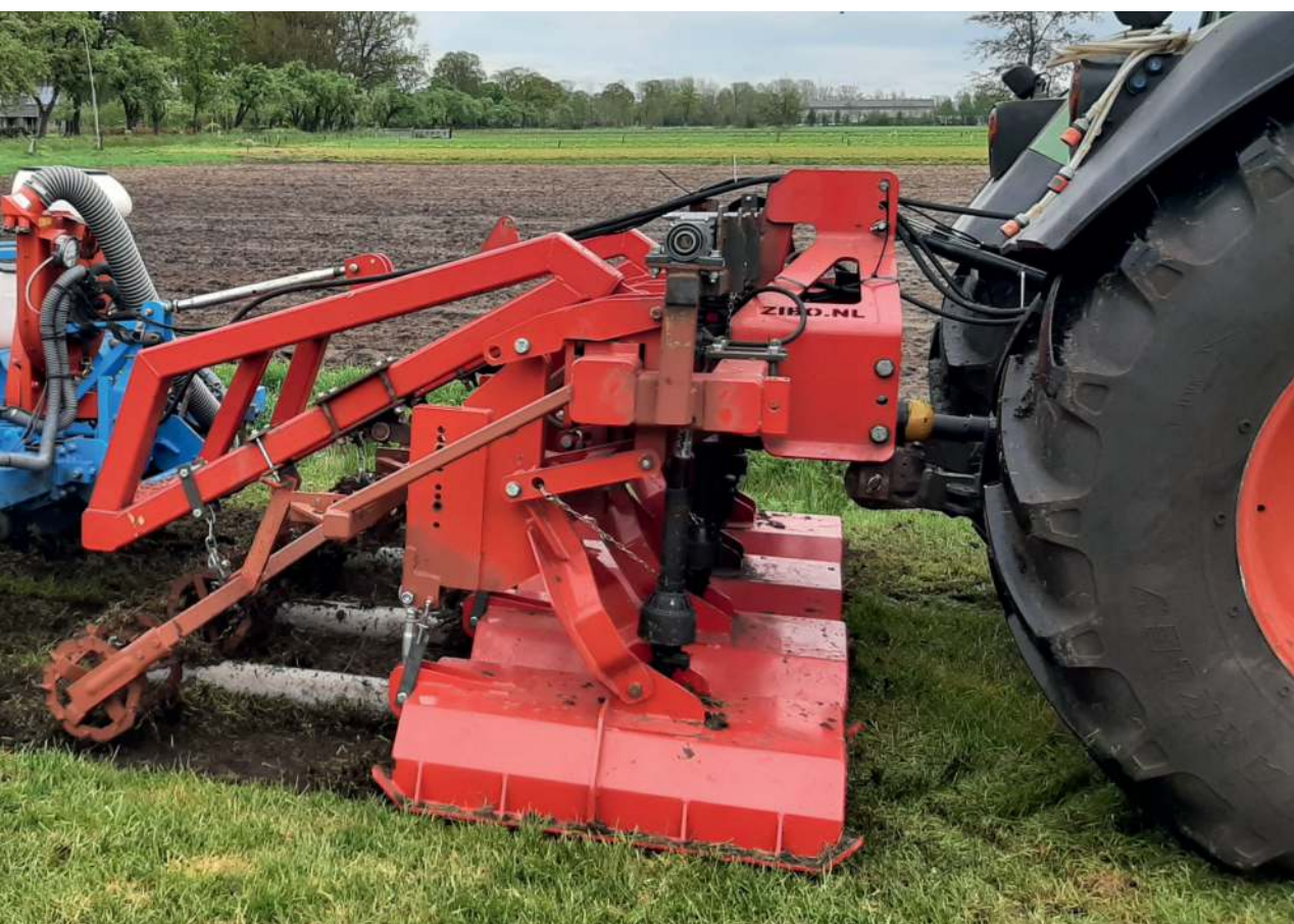
De strokenmulcher mulcht in een strook van 60 centimeter breed de graszode met 2 tot 3 centimeter van de grond. In dezelfde werkgang wordt de mais in de strook gezaaid.
