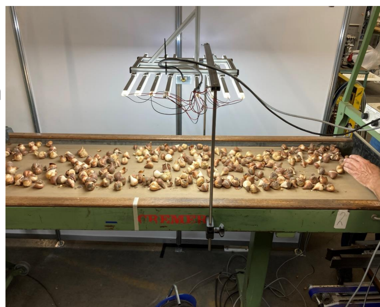
Figuur 1. Bollen in grotere stroom over Cremer leesband
