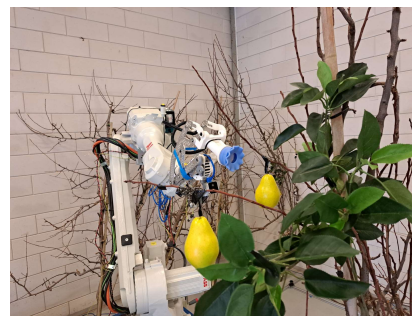
Figuur 2. Mobiele proefopstelling met robot arm en gripper in test opstelling
