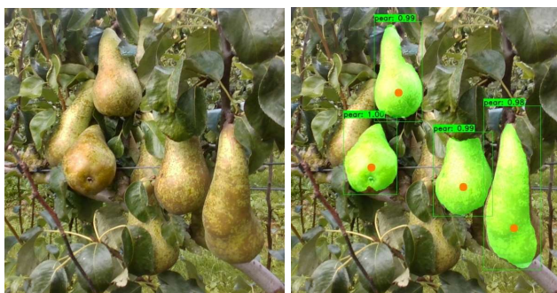
Figuur 1. Linker afbeelding: kleurenbeeld opgenomen met de robot camera. Rechter afbeelding: Keypoint R-CNN-detectie. Groene pixels zijn de gedetecteerde peren, rode stippen zijn de gedetecteerde keypoints/aangrijppunten voor de robot gripper. De betrouwbaarheidsdrempel van het detectienetwerk is op een hoge waarde ingesteld, zodat alleen de peren met een hoge detectiescore worden weergegeven. Meestal zijn dit de peren die zich dicht bij de camera en dus robot bevinden.
