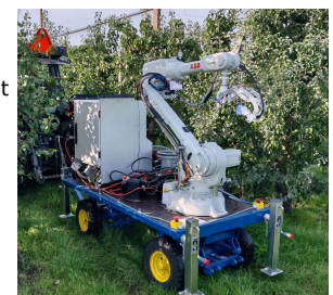
Figuur 3. Experimenten in de boomgaard met de plukrobot.
