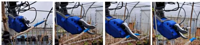
Figuur 2. Succesvolle snoeidemonstratie met het prototype end-effector
