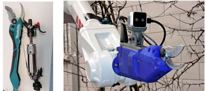
Figuur 4. Onderdelen accu snoeischaar (links) en end-effector op de robotarm (rechts)
