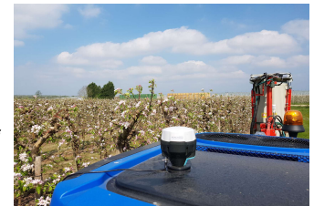
Figuur 3. GPS (voorzicht) is nodig om precisiespuit (achtergrond) te laten spuiten op boomniveau
