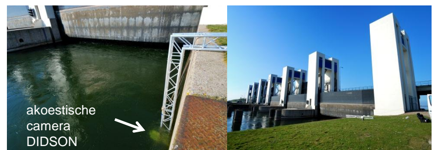
Opstelling bij de spuikokers bij de Houtribdijk waar met de DIDSON gekeken wordt naar de uitwisseling van vis tussen het Markermeer en IJsselmeer.
