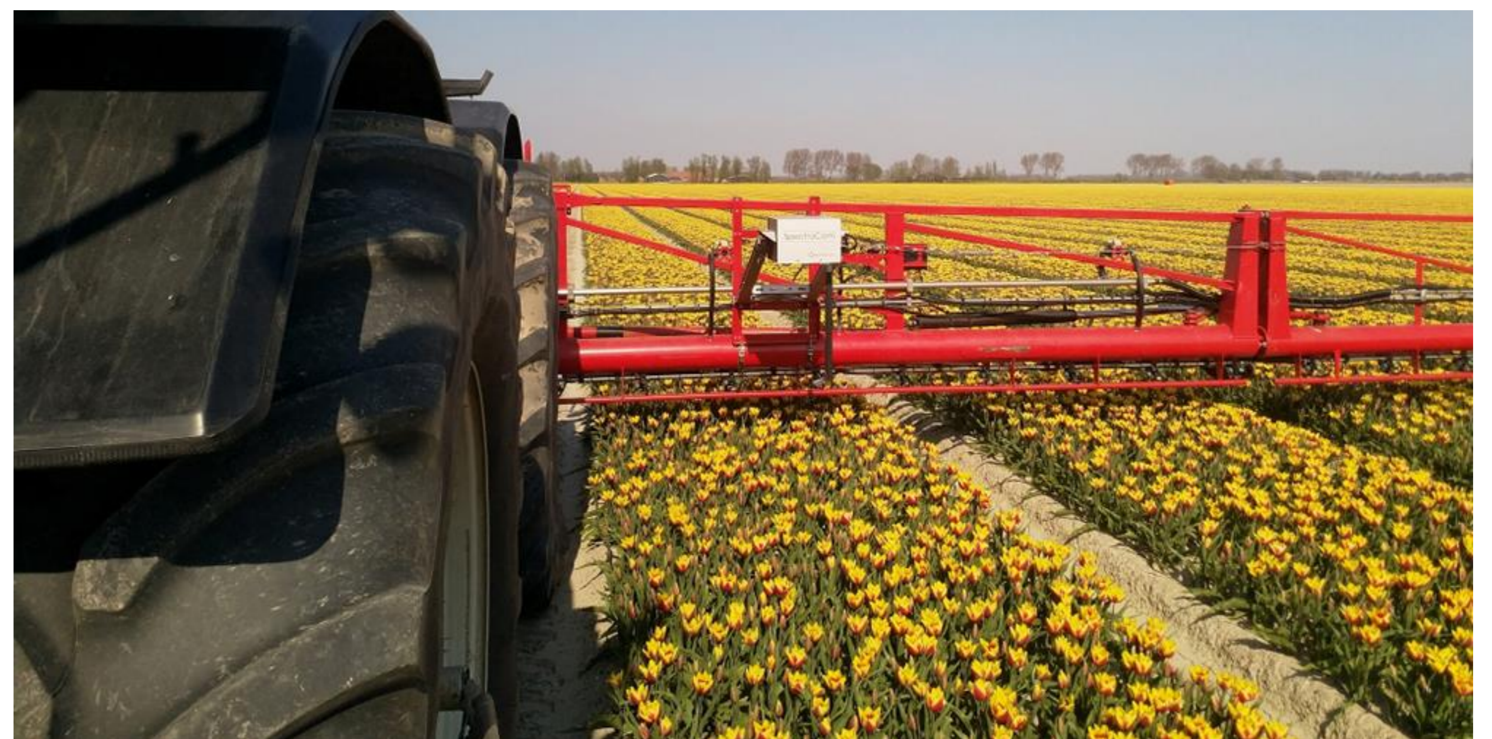
Figuur 4. De Spectracam gemonteerd aan Agrifac veldspuit tijdens seizoen 2020. De sensor meet de gewasreflecties boven één bed tulpen en representeert daarbij de omgeving in grotere percelen van dezelfde cultivar.
