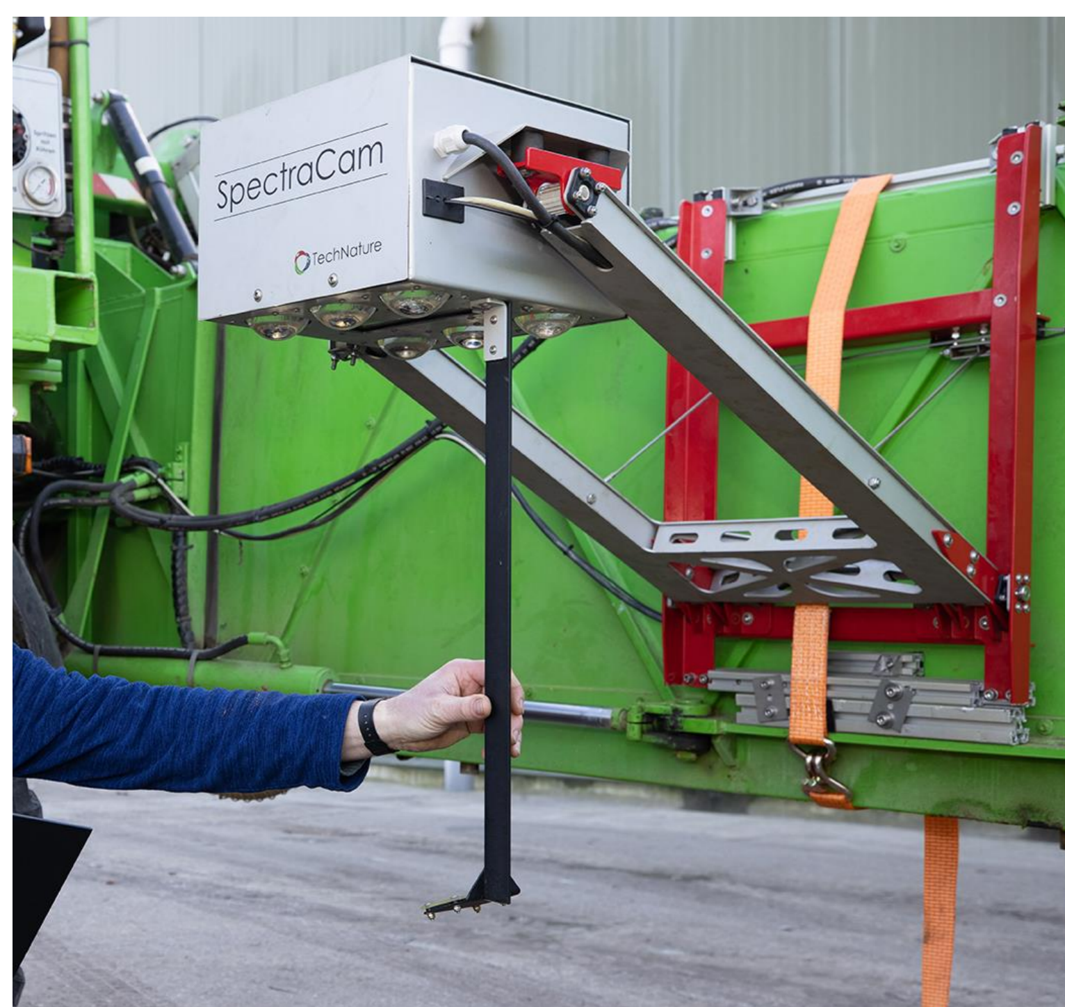
Figuur 2. De Spectracam sensor gemonteerd op de veldspuit bij de bollenteler tijdens seizoen 2021 en 2022. In de sensor meerdere camera's die gewasreflectie meten en onder de sensor de referentiestandaard.
