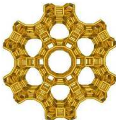
Structuur zeoliet, werkt als een zeef
